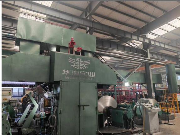
图 3-3 轧制废气收集图
