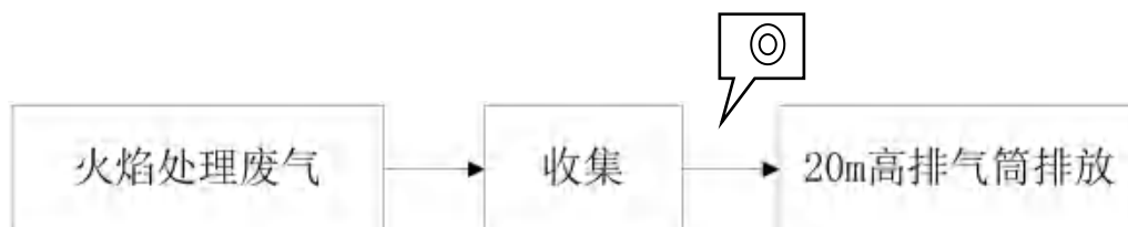
图 4-18 火焰处理废气处理工艺流程图
