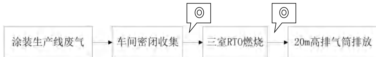
图 4-3 涂装生产线废气处理工艺流程图
