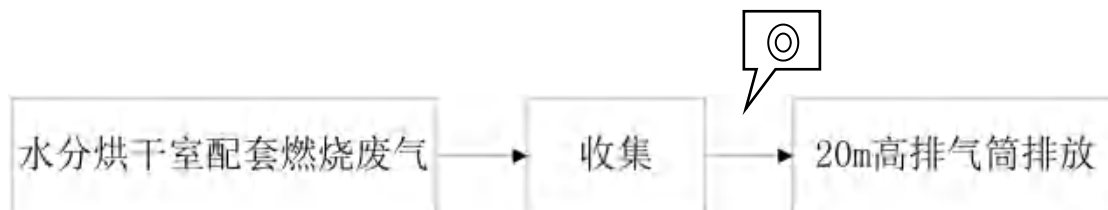
图 4-11 水分烘干室配套燃烧废气处理工艺流程图
