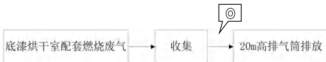
图 4-13 底漆烘干室配套燃烧废气处理工艺流程图
