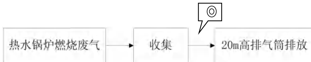
图 4-16 热水锅炉燃烧废气处理工艺流程图
